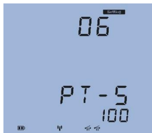
Fig 3.67 PT تنظیم ثانویه
