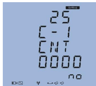
Fig 3.142 شماره کنتاکت خازن ۱
