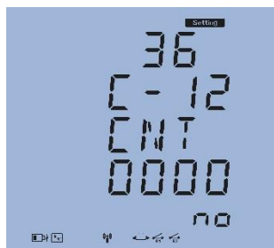
Fig 3.143 شماره کنتاکت خازن ۱۲
