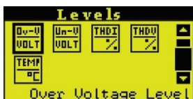
تنظیم مقدار بیشینه ولتاژ Figure 73
