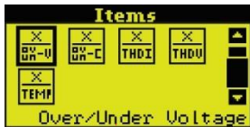
Figure 62 حفاظت از ولتاژ خارج از محدوده غیرفعال
